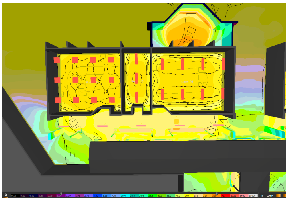
Figura 21 - Resultado da Simulação no Dialux (Cores Falsas) – Interno Auditorio, Sala dos professores e midiateca.
