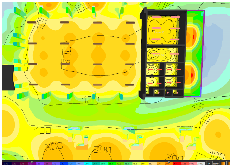
Figura 24 - Resultado da Simulação no Dialux (Cores Falsas) – Interno refeitório e cozinha.
