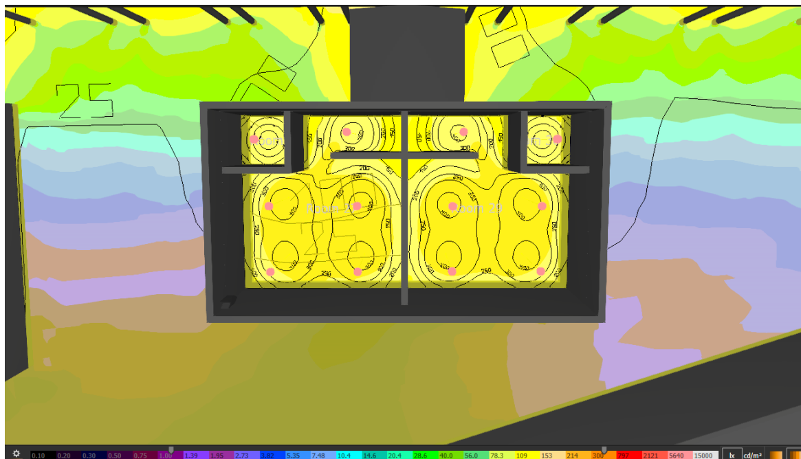
Figura 26 - Resultado da Simulação no Dialux (Cores Falsas) – Interno vestiário.
