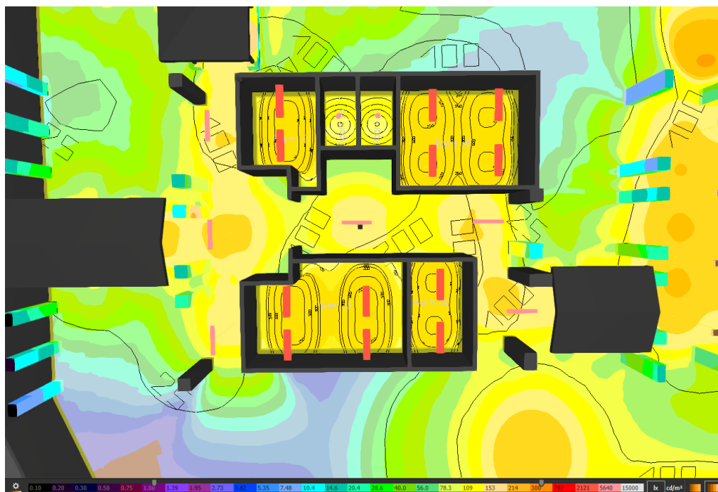
Figura 20 - Resultado da Simulação no Dialux (Cores Falsas) – Interno Administrativo
