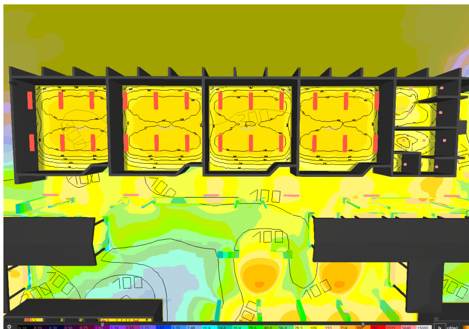
Figura 22 - Resultado da Simulação no Dialux (Cores Falsas) – Interno salas 3 a 6 e banheiros.
