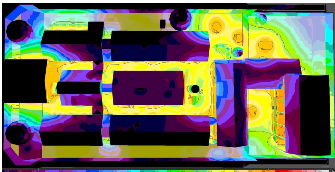
Figura 26 - Resultado da Simulação no Dialux (Cores Falsas) – Externo Geral
