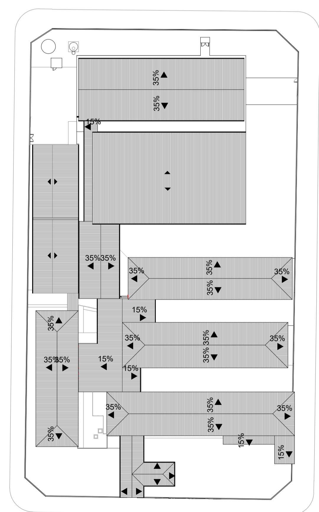
PLANTA DE COBERTURA ESCALA 1:500
